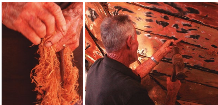
Figura 3. Detalhes da corda da fibra de embira e o processo de vedação feito por Raimundo Alves, calafate. Créditos: Carolina Rüde.
