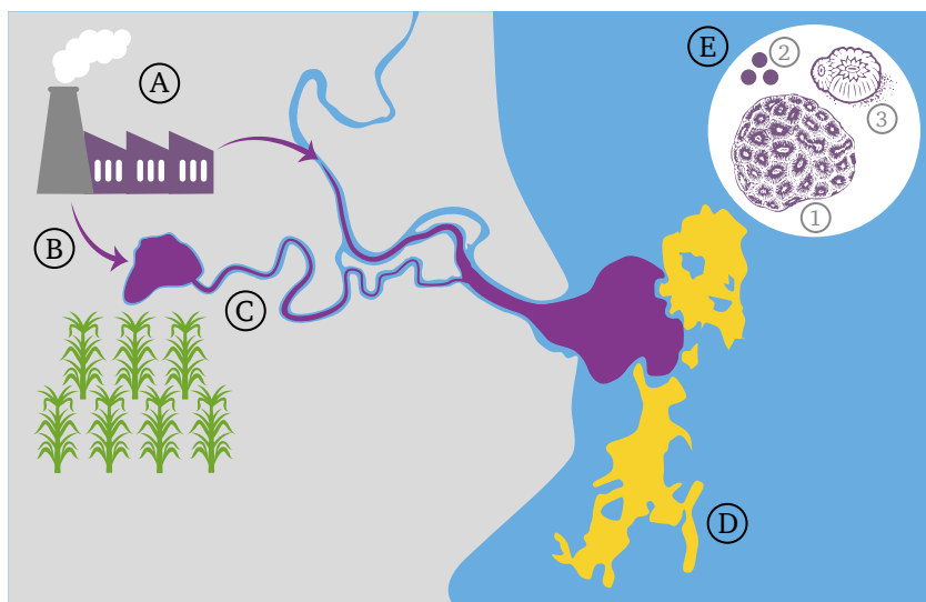
Figura 1. Esquema da poluição fluvial-marinha causada pelo vinhoto antes da proibição de seu derrame nos rios. (A) Da destilaria da usina, (B) o vinhoto gerado era diretamente despejado nos rios ou seguia para lagoas de tratamento onde ficava contido, sendo posteriormente (C) enviado aos rios. (D) Percorrendo os rios, o resíduo poderia chegar à região estuarina onde, em Pernambuco, encontra-se a maioria dos recifes e (E) sua mancha poderia afetar os corais nas fases de vida (1) adulta, (2) larval e (3) de recrutas.
