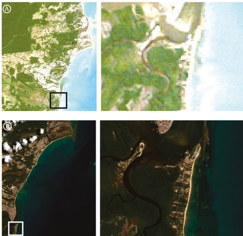
Figura 4. Diferenças nas resoluções espaciais das imagens dos satélites WorldView 2 e Landsat 5. Imagens da esquerda com escala de 1:100.000 e da direita com escala de 1:15.000. (A) Imagem Landsat - Resolução espacial 30m. (B) Imagem WorldView 2 - Resolução espacial 02m.
