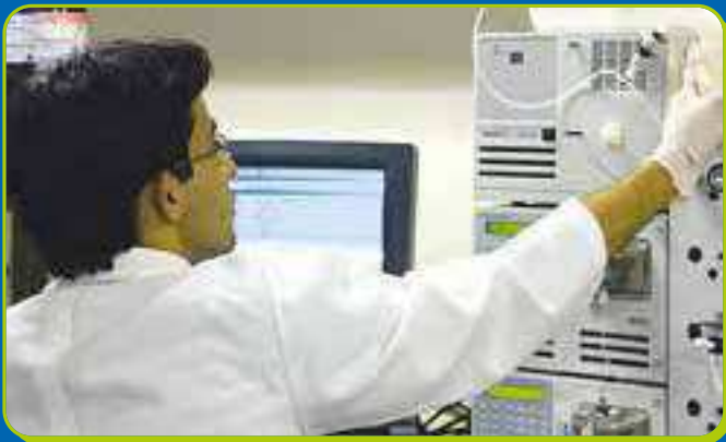
Carlos Roberto de Souza Filho, aluno do Curso de Biomedicina (UCB) usando o aparelho "High Performance Liquid Chromatography (HPLC)", que purifica e separa as moléculas proteicas presentes nos extratos dos animais marinhos dos recifes
